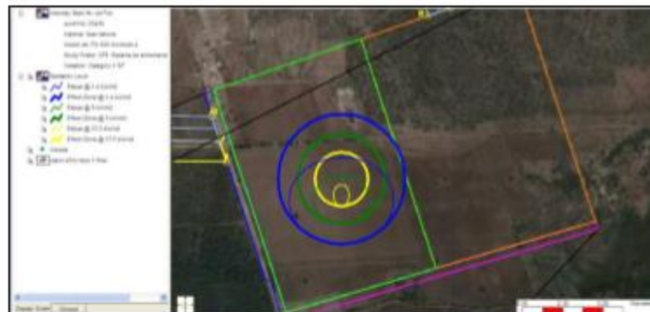
Figura 1. Intensidad de radiación de incendio de chorro por fuga grande en línea de 8"
