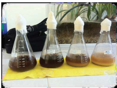
Fig. 6. Fermentación alcohólica de las muestras, incubadas a 40 °C / 72 h con S. cerevisiae .
