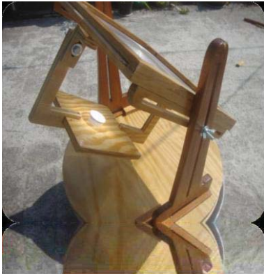
Fig. 20. Prototipo de Concentrador Solar tipo Lente de Fresnel construido en la Facultad de Ingeniería UNAM para uso didáctico
