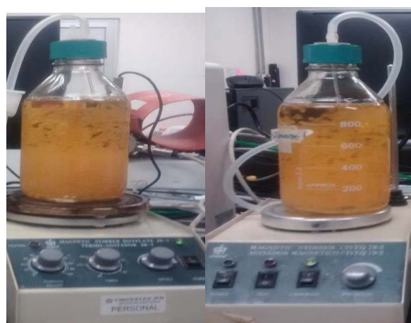
Figura 1 Configuración de frascos agitados mecánica y neumáticamente.
