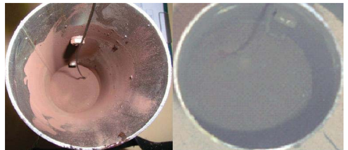
Fig. 9. Reducción de Hematita a Magnetita [2]
