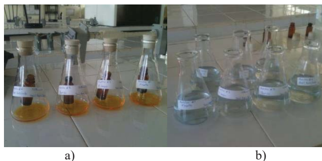
Fig. 7. Determinación de etanol en solución acuosa. a) preparación de muestras. b) valoración final de la muestra con Na_2S_2O_3 .
