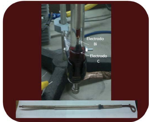
Fig. 2. Electrodo centrado dentro de tubo de vidrio.
