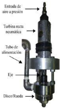
Figura 2. Atomizador de disco rotatorio.
